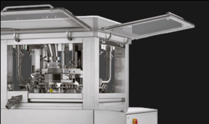
Kompaktes Design: Neben dem integrierten Schaltschrank sorgen raumsparende Fensterklappen für einen minimierten Platzbedarf mit 360-Grad-Zugang und dem größten Pressraum dieser Klasse.
