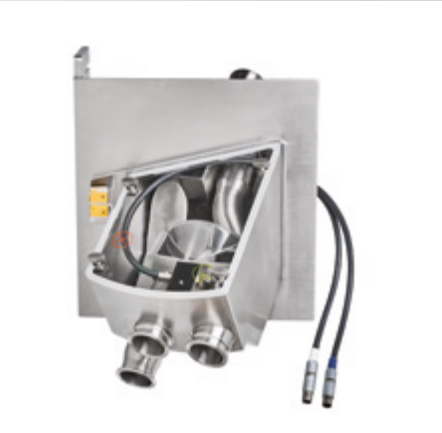
Ein multiflexibler Tablettenablauf reduziert das Risiko von Materialstaus.
