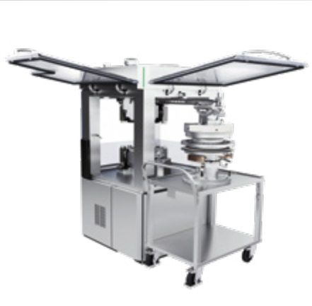
Über einen integrierten Ausbauträger lässt sich der Rotorwechsel bei der F20i in wenigen Minuten bewerkstelligen.
