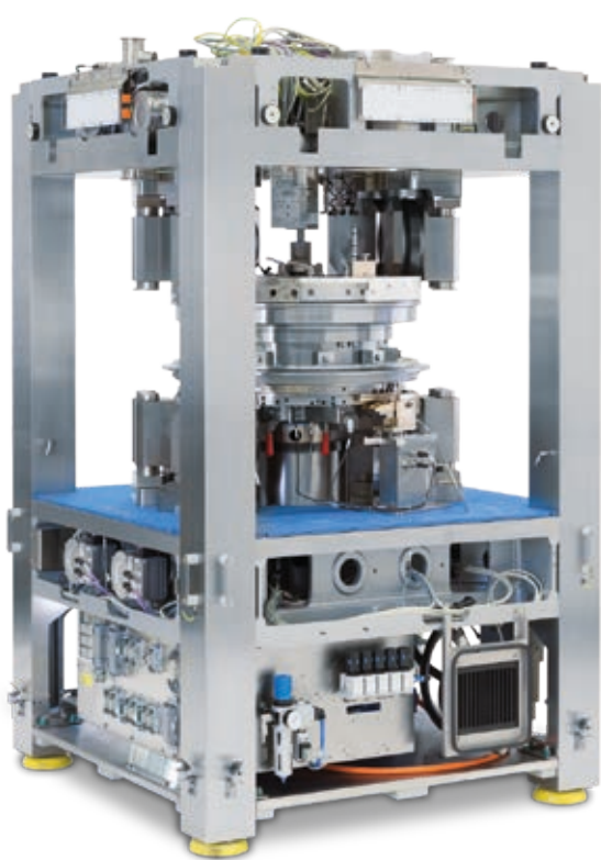
Gebrauchte Tablettenpresse nach professioneller Aufarbeitung
