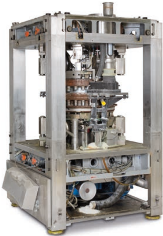
Gebrauchte Tablettenpresse vor der Aufarbeitung
