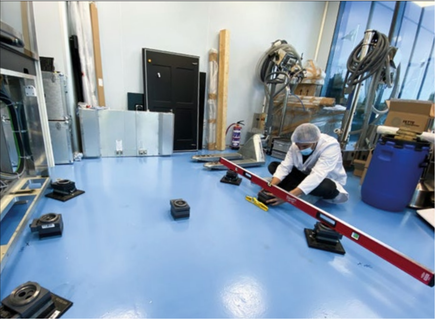
Ausrichtung der Maschinenfüße einer FEC20 in Spanien: Dank digitaler Vernetzung mit dem Team in Deutschland muss nur ein einziger Servicetechniker vor Ort sein (im Bild: Albert Vilà von Fette Compacting Iberica).
