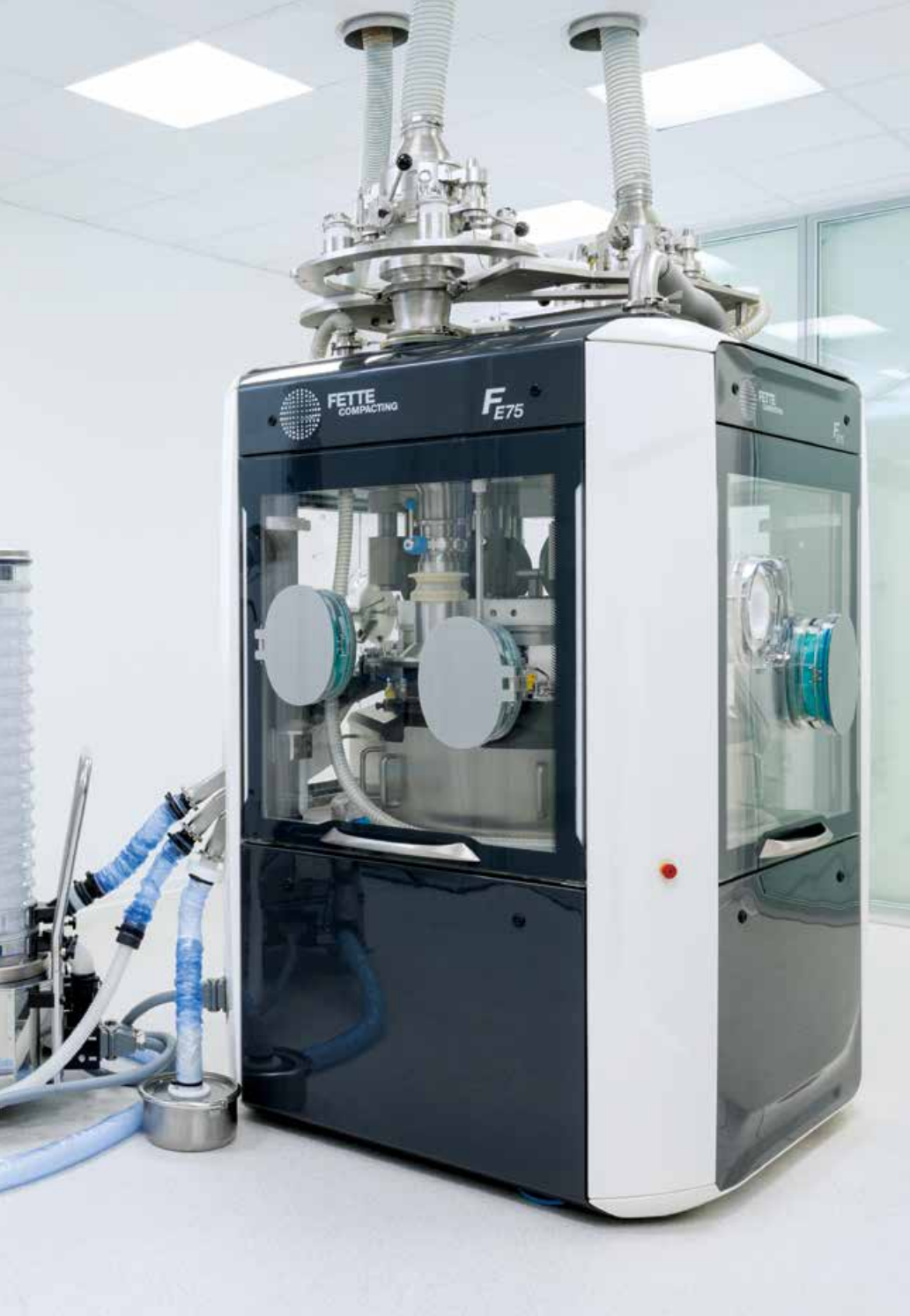
FE75 in 2-Schicht-Produktion mit Containment-Paket und entsprechendem Prozess-Equipment
