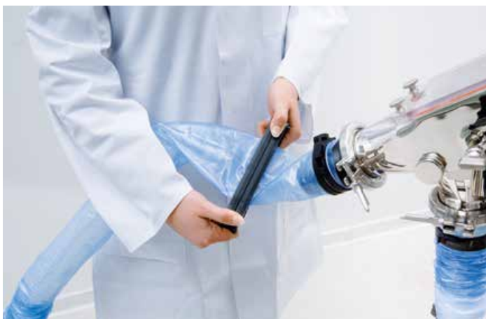
Liner-System als Verbindungselement der einzelnen Systemkomponenten
