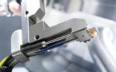
NIR-Sensoren in der Tablettenpresse analysieren die Wirkstoffkonzentration der Produkte.
