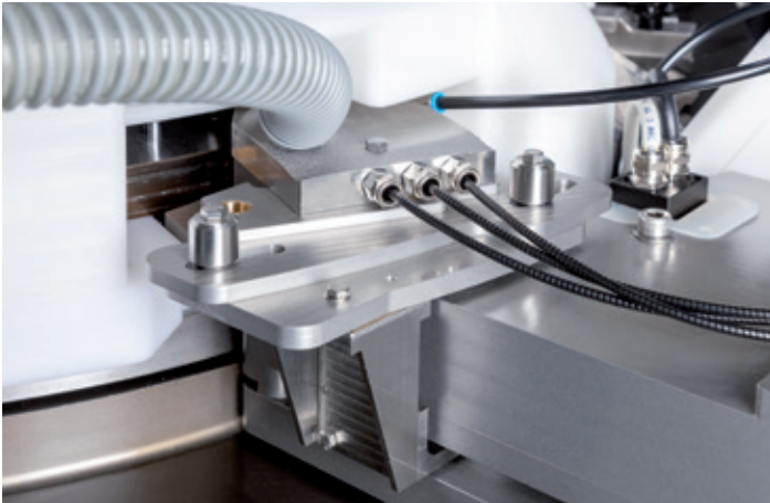
TU-NIR-Sensor: 100%ige Hochgeschwindigkeits-Qualitätskontrolle und Aussortierung jeder Tablette, die als nicht spezifikationsgerecht erkannt wird
