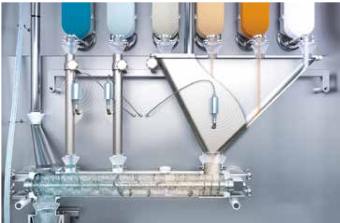
Unterschiedliche Formulierung, gleichmäßiger Pulverfluss – durch Ultraschall
