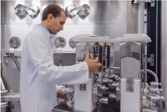
Werkzeuglos: Bestandteile wie Mischer, Trichter und Dosierer lassen sich mit wenigen Handgriffen entnehmen.
