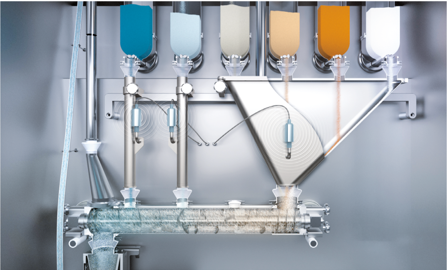
Ultraschall bringt Pulver in Schwingung und trägt zu einem gleichmäßigen, stabilen Materialfluss bei.
