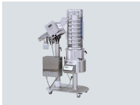
KD 6015 Schonende Tablettenentstaubung mit automatischer Vibrationsregelung für konstant stabile Prozessbedingungen.
