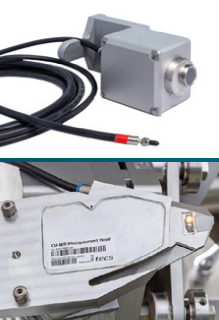
Sensoren zur Messung der Mischung (oben) und der Tablette (unten).
