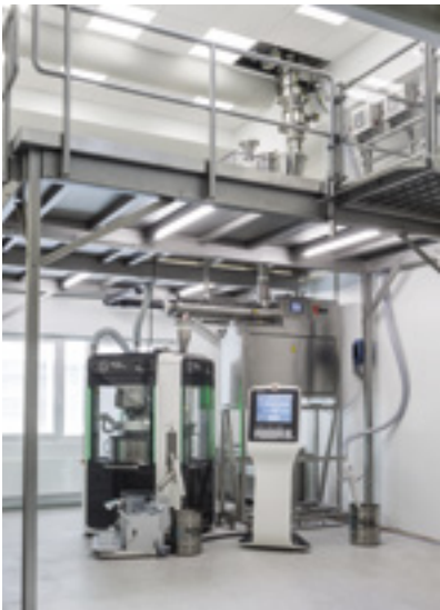
Beispielhafter Gesamtaufbau einer kontinuierlichen Direktverpressungsline mit Materialzufuhr und Dosierern (obere Etage), Mischsystem und Tablettenpresse (unten).
