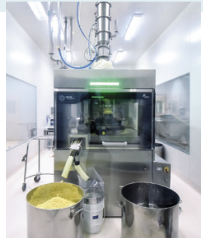
Die Tablettenpresse P3030 bildet das Herzstück der kontinuierlichen Produktion bei BY-HEALTH.
