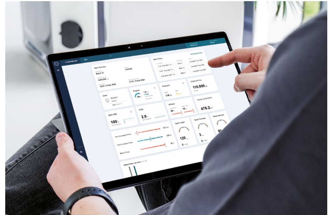
Der ConditionMonitor sammelt sämtliche Informationen der Produktionsmaschinen und stellt die wichtigsten Parameter in einem Dashboard zusammen.
