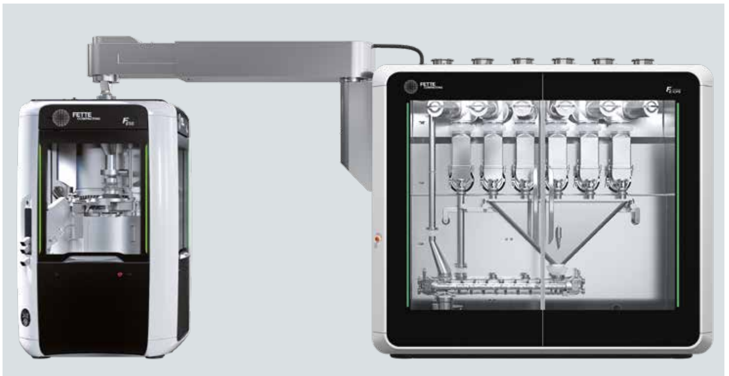
Configuração horizontal A FE CPCS conectada a compressora: Linha de Compressão Direta Contínua (CDC)
