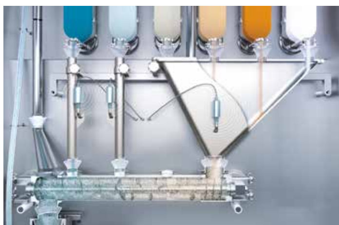
Diferente formulação, fluxo uniforme de pós – mediante ultrassons
