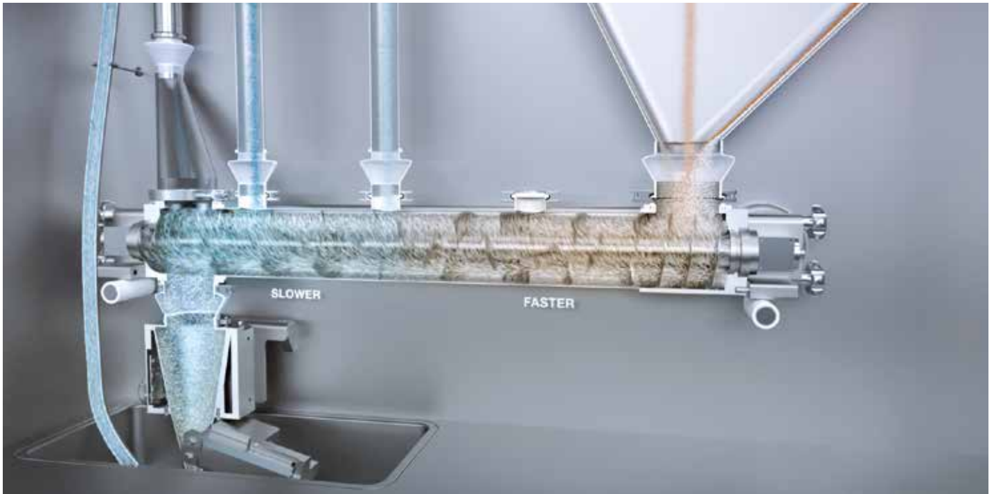
Misturadora (patente pendente*) duas velocidades distintas em uma única rosca
