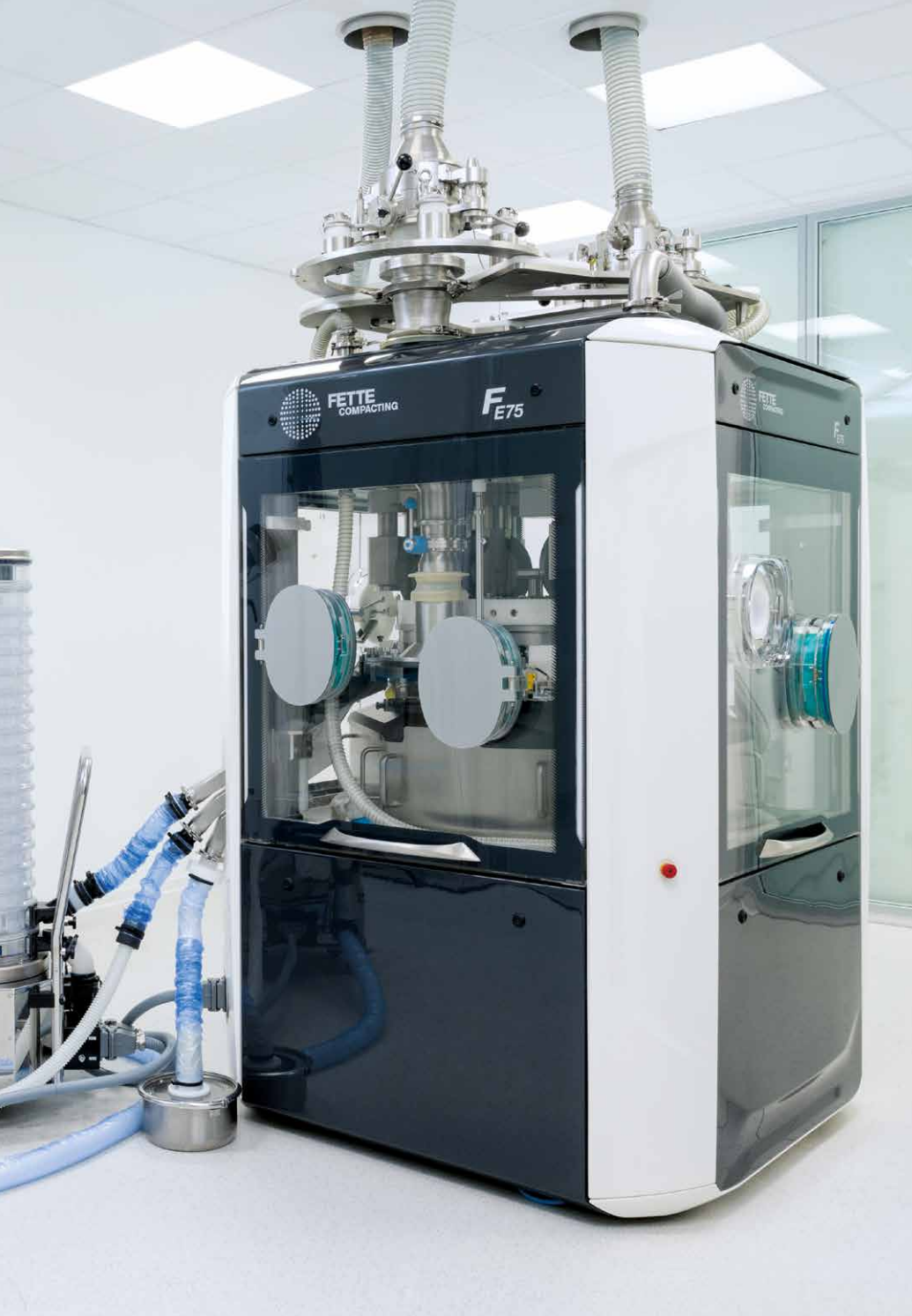
FE75 para produção de 2 camadas com pacote de contenção e equipamento de processamento correspondente
