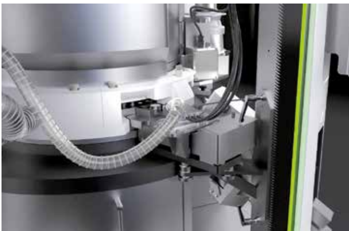
Compressora equipada com sensor BU-NIRS no FOM e TU-NIRS para controle e rejeição de comprimidos isolados
