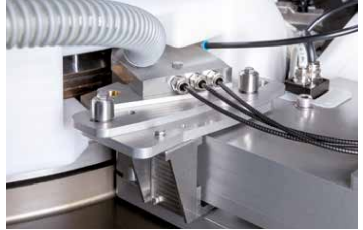
Sensor TU-NIRS: Controle de 100 % da qualidade a alta velocidade e rejeição de todos os comprimidos que não cumprem as especificações
